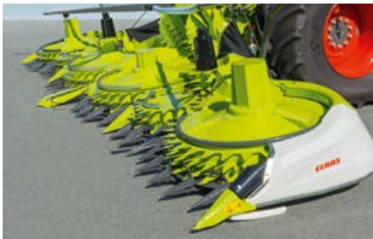
Architecture très plate pour une faible hauteur de coupe.
