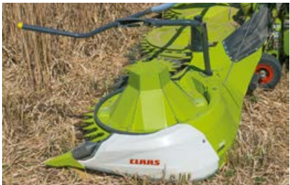
Le grand cône pour maïs versé optimise le flux de récolte et empêche la récolte de s'accumuler sur le disque de transport.
