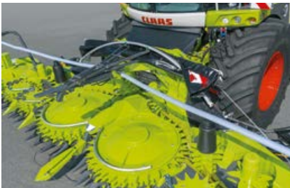
Compacité et vue dégagée sur l'ORBIS pendant la récolte. La protection de transport est repliée en toute sécurité sur la machine.
