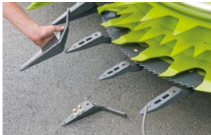
Les pointes démontables facilitent le ramassage du maïs versé.
