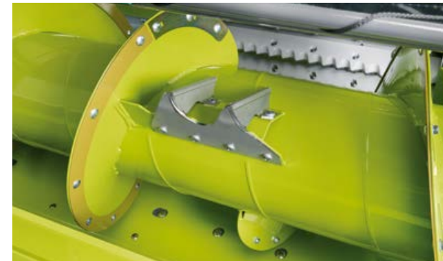
Vis sans fin d'alimentation avec diamètre de 600 mm pour des débits élevés.
