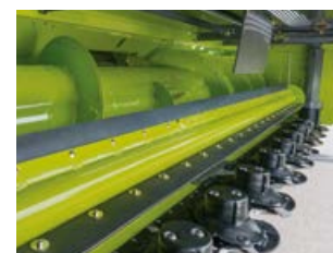
DIRECT DISC 600 P / 500 P avec réglage hydraulique de série de la hauteur du rouleau à pales.
