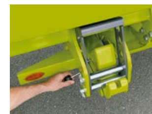
Verrouillage pour une grande sécurité sur la route même à des vitesses élevées (jusqu'à 40 km/h).
