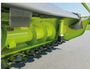
DIRECT DISC 600 / 500 avec vis sans fin d'alimentation de grand diamètre.
