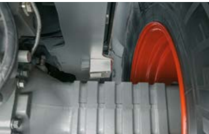
Det er muligt at begrænse bagakslens pendulbevægelse for at gøre det muligt at anvende ekstra høje dæk til landbrugsopgaver.
