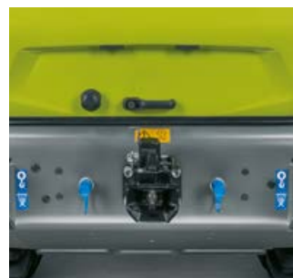
På bagenden er yderligere to lynkoblingselementer.
