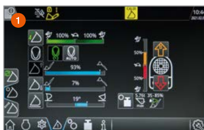
Løftehøjde- og sænkebegrænsningen gemmer den ideelle nærhed til jorden og udtipningshøjden.
