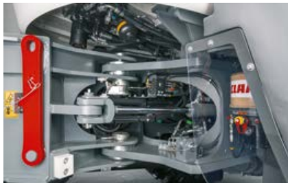
Knækleddet med 40° knækvinkel gør TORION smidig og agil.
