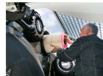
Udskiftning af luftfilter uden brug af værktøj
