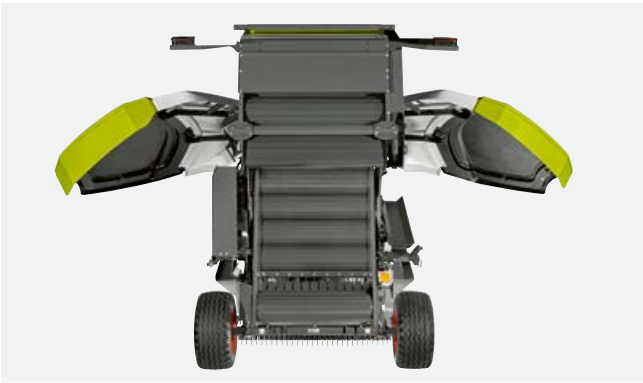
El concepto de cámara fija de ROLLANT 620.
