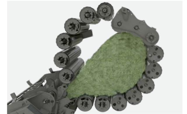
MAXIMUM PRESSURE SYSTEM II for ROLLANT 520 and ROLLANT 540.
