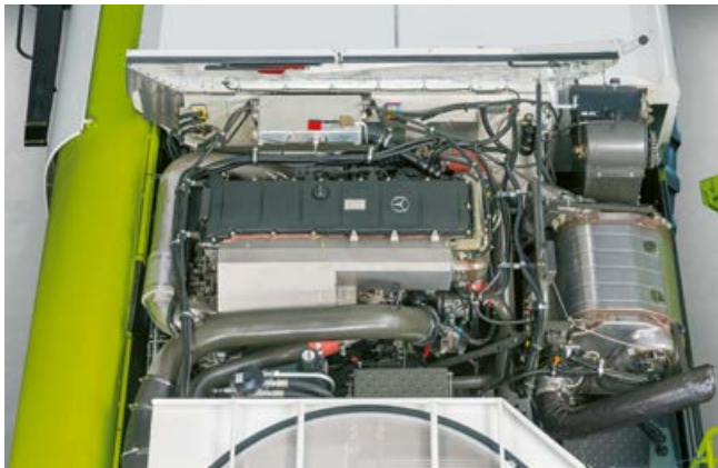
Mercedes Benz OM 473 met 460 kW/626 pk voor LEXION 8700.
