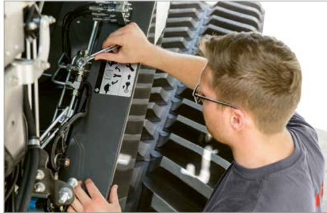
Превключвате ръчно двата диапазона на оборотите на редуктора на оборотите на вършачния барабан чрез хидравличен клапан.
