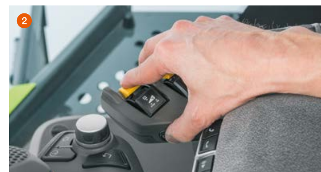
Visszaforgatás a CMOTION karon keresztül (1) vagy a kartámaszon lévő billenőkapcsoló és visszaforgató gomb (2) egyidejű megnyomásával
