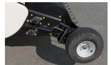
A támkerek biztosítják a megfelelő mélységet
