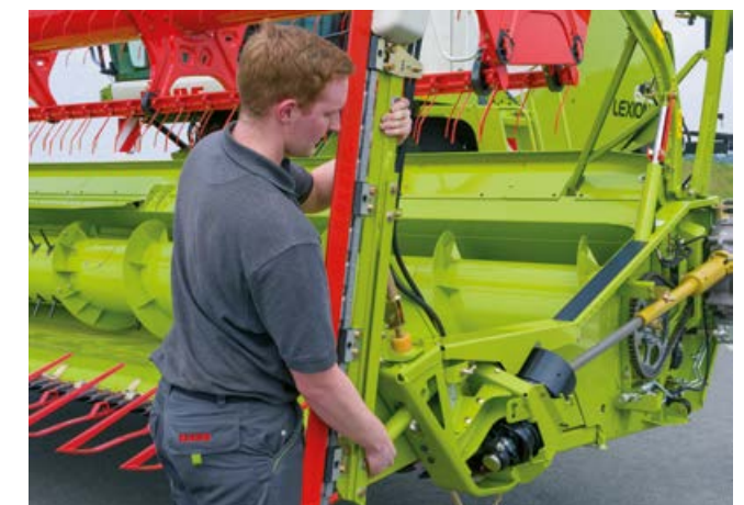
A repcekasza felszerelése gyorskapcsolóval
