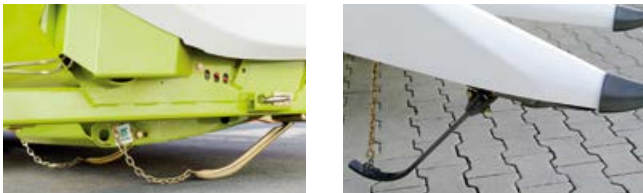
Az érzékelő csápok rögzítik az adapter helyzetét az AUTO CONTOUR és CONTOUR esetén.
