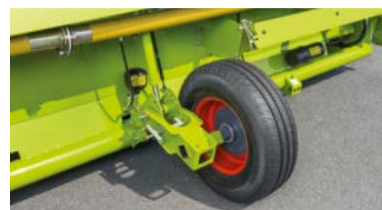
A támkerek minden betakarítási körülmény között biztosan vezetnek az adaptert.
