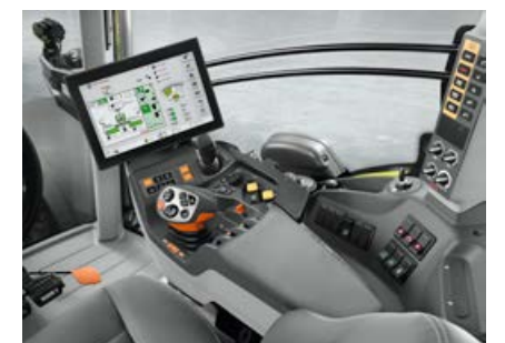
Teljesen ISOBUS kompatibilis traktor esetén a DISCO CONTOUR vezérlése az ISOBUS terminálon keresztül valósul meg.
