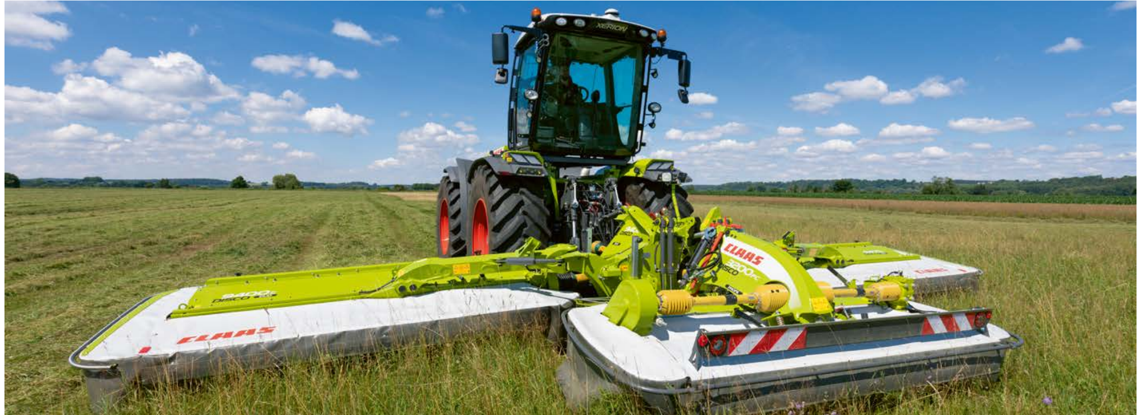
Az átlátható elrendezés csökkenti a vezetőt ért stresszt és növeli a kaszási termelékenységét.
