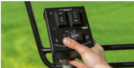
A DISCO 1100 TREND rendelkezik egy praktikus irányítóegységgel az egyenkénti kasza-kiemelés funkcióhoz, amivel szállítási állapotba hajtható, miközben az egység a lámpák ki- és bekapcsolására is lehetőséget nyújt.
