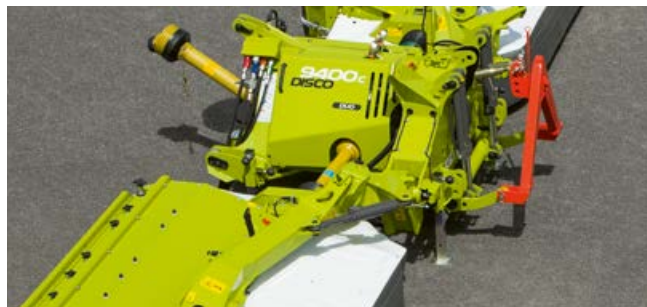
A hidraulikus, folyamatos ráhajtás elleni védelem működése során ütközés esetén a kasza kileng és automatikusan visszaáll alaphelyzetbe.
