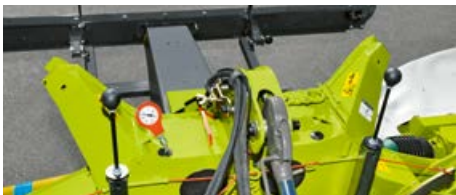
Nyomásmérő tárcsa, amivel kényelmesen beállítható mindkét kaszatárcsánál a talajnyomás.
