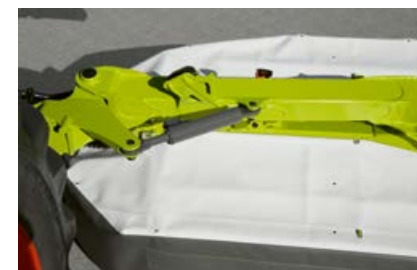
A hidraulikus és folyamatos ráhajtás elleni védelem működése közben ütközés esetén a kasza elmozdul, majd automatikusan visszaáll alaphelyzetbe.
