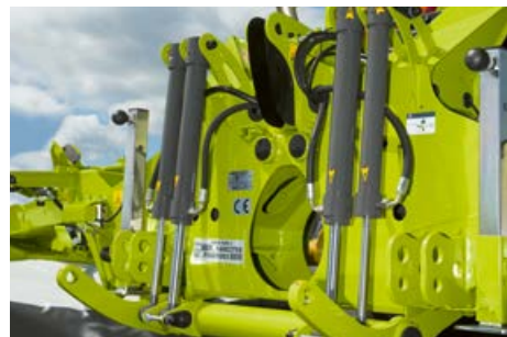
Az ACTIVE FLOAT rendszer szabványos emelő- és felfüggesztő dugattyúi megbízható védelmet nyújtanak a fűtakaró számára.
