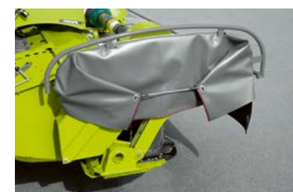
Az alacsony forgópontnak köszönhetően a DISCO PROFIL kaszák a talajt követik és nem a traktort.
