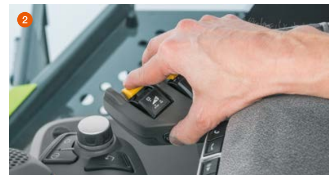
Reversering med CMOTION (1) eller med tryck på vippbrytaren och reverseringsknappen (2) samtidigt.
