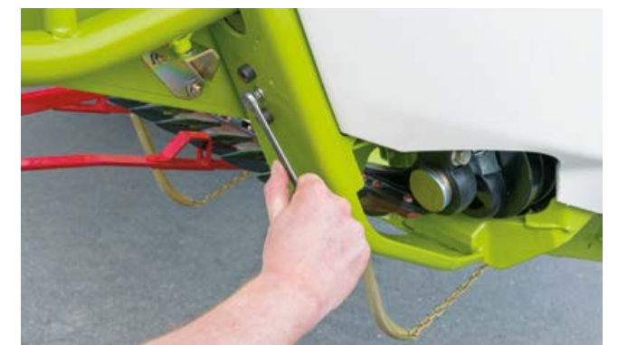
Enkel höjdjustering av stråskiljare med justeringsnyckel.
