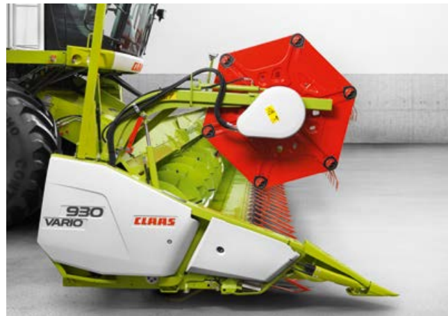
Skärbordsbotten förkortad – spannmål (-100 mm).
