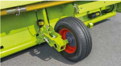
Stabiliseringshjul styr skärbordet exakt under alla förhållanden.
