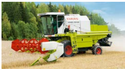
Skärborden C 450 och C 420 kan båda användas till DOMINATOR 130.
