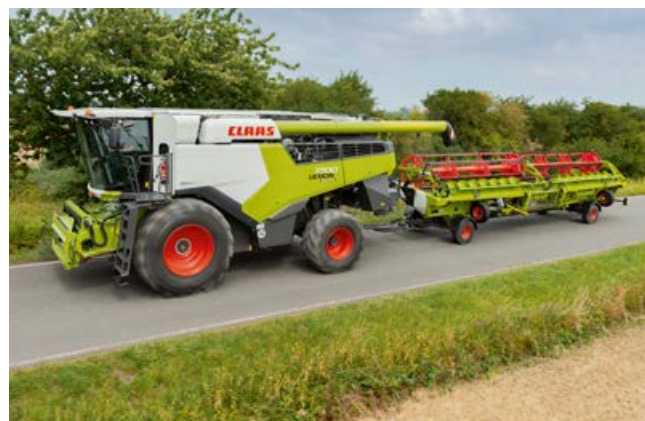
CORIO 1275 C på skärbordsvagn med två axlar.
