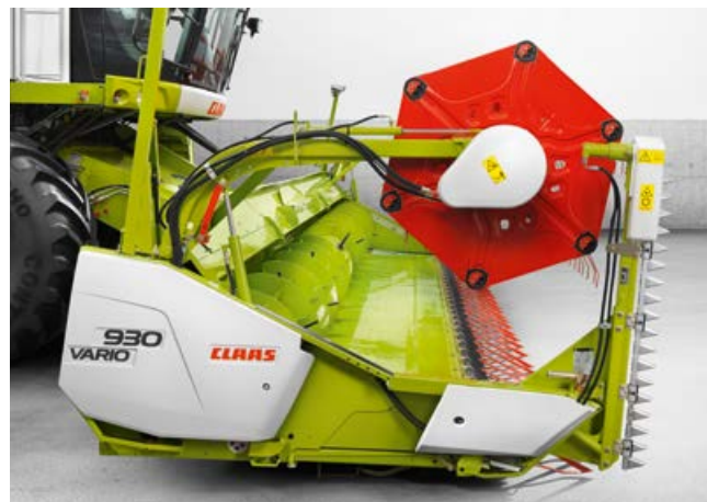
Skärbordsbotten förlängd – med rapssidoknivar (+600 mm).
