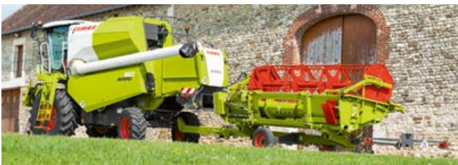
Skärbordsvagn för snabb flyttning mellan fälten, även på längre avstånd.
