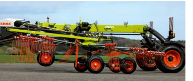
Jet Effect: emelés és süllyesztés közben a rotor úgy viselkedik, mint egy repülőgép fel- és leszállás közben.
