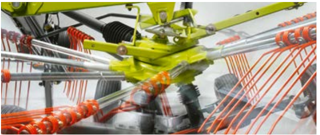
A kardáncsukós rotorfelfüggesztés biztosítja a rotorok traktortól független talajkövetését.
