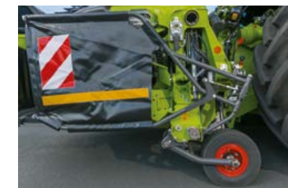
Hyvä ajomukavuus, kun kuljetusjärjestelmän heiluntavaimennus on käytössä.
