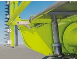
Säädettävä painintela, lisävarusteena myös hydraulinen säätö.
