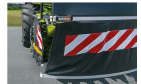
Varoitustarroilla varustetut sivu- ja etusuojukset ovat hyvin näkyvissä. LED-valot ovat täysin integroidut.
