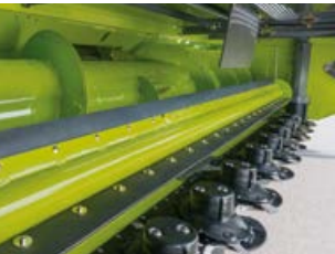
DIRECT DISC 600 P / 500 P lisävarusteena saatavalla, hydraulisella korkeussäädöllä varustetulla, siipitelalla.
