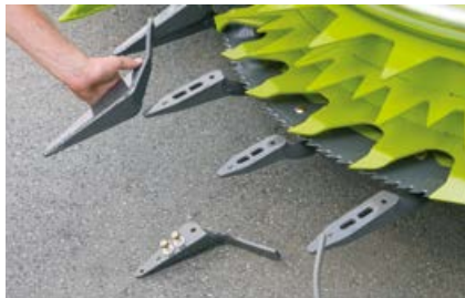
Irrotettavat ohjainsormet parantavat lakomaissin nostoa.
