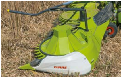
Suurikokoinen lakomaissikartio optimoi materiaali-virran ja estää materiaalin viipymisen kuljetuslaute-sella.
