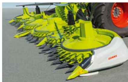
Erittäin matala rakenne mahdollistaa lyhyen sängen.
