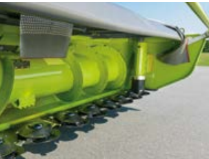
DIRECT DISC 600 / 500 suurikokoisella syöttökierukalla.
