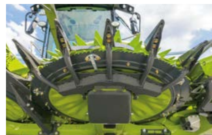
Vankat ohjaimet ja kaapimet terälautasten alla pitävät ne puhtaana.
