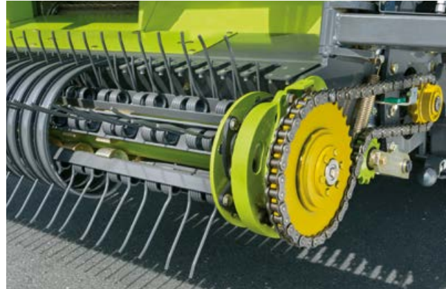
Vahvat noukinpiikit varmistavat puhtaan rehun noston.
