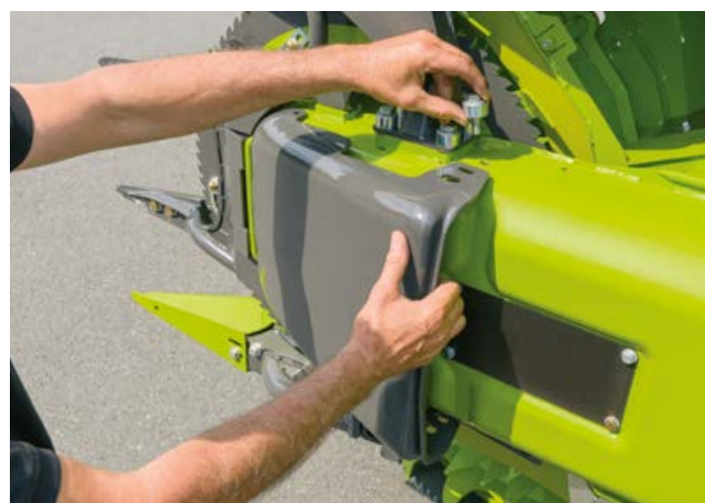
Liukujalaket kaksivaiheisella korkeussäädöllä.
