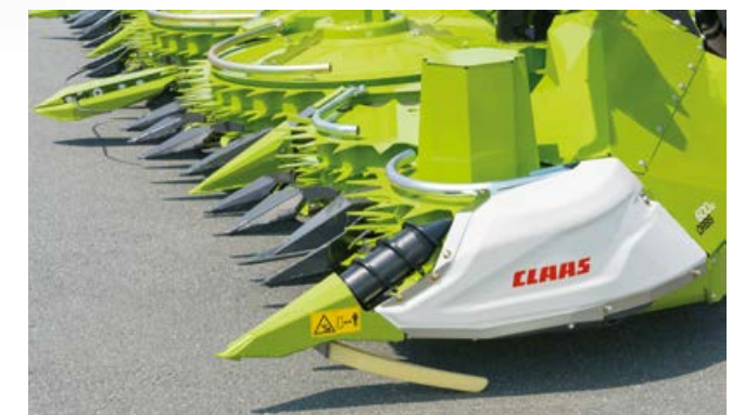
Tarpeen vaatiessa lakomaissiruuvien käyttö on hydraulinen.
