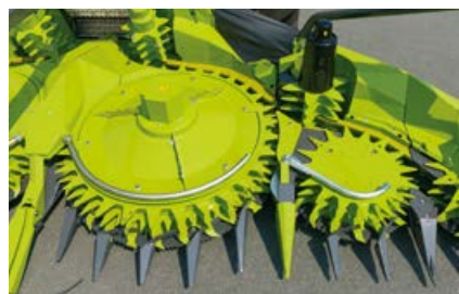
Varma materiaalin siirto syöttökanavassa.
