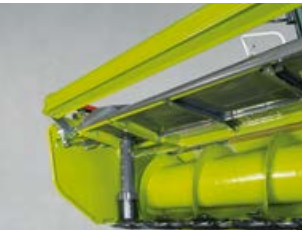
Painintela varmistaa erittäin tasaisen materiaalin siirron.
