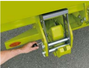
Lukituksen jälkeen kuljetus on turvallinen, jopa 40 km/h nopeudella.
