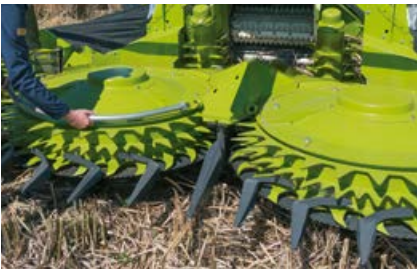
Tähtäkourujen irrotus lisää materiaalivirran nopeutta.
