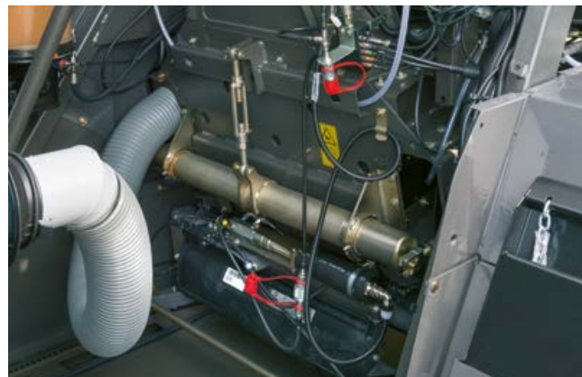
Kiihdytyspuhaltimen mekaaninen välin säätö.
