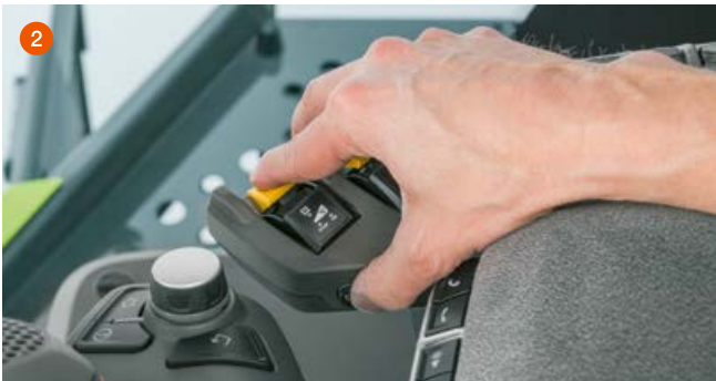
Terugdraaien met CMOTION (1) of door tegelijkertijd op de tuimelschakelaar en de omkeerknop (2) te drukken
