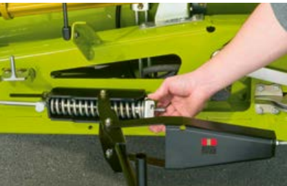
De rechte loop en de juiste bandspanning zorgen voor de duurzaamheid van de banden.
