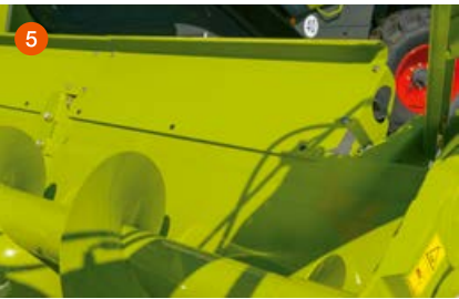
De extra achterwandverhoging (5) voorkomt dat verlies optreedt bij het oogsten van koolzaad.
