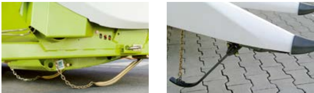
Tastbeugels registreren de stand van het voorzetstuk voor AUTO CONTOUR en CONTOUR
