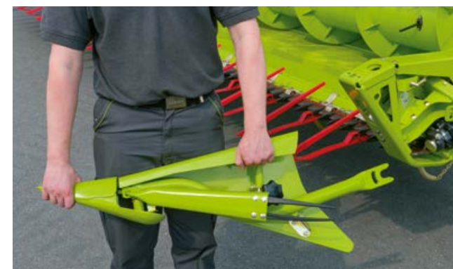
Snel en eenvoudig demonteren van de halmverdelers.
