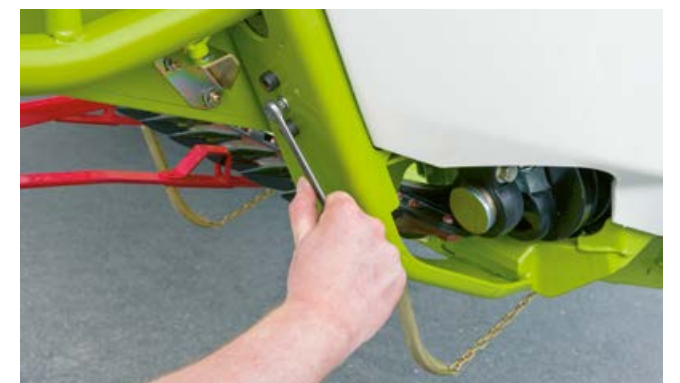
Eenvoudige hoogteverstelling van de halmverdelers met een inbusleutel.
