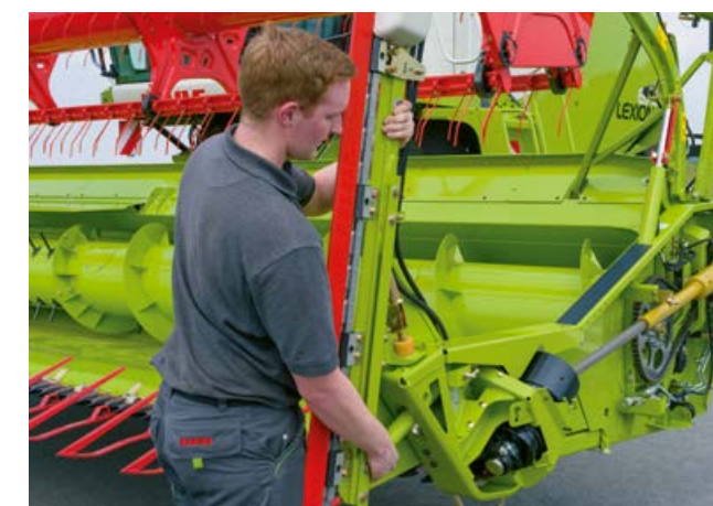
Koolzaadmessen worden met snelsluiting bevestigd.
