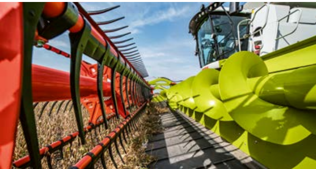
Door de curvebaan gestuurde haspel met flip-over-concept
