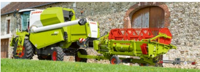
Met de transportwagen kan het maaibord snel en eenvoudig worden verplaatst, ook wanneer de percelen ver uit elkaar liggen.
