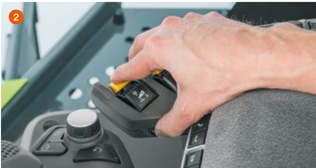
Reversering med CMOTION (1) eller ved tryk på vippekontakten og reverseringstasten (2) samtidig
