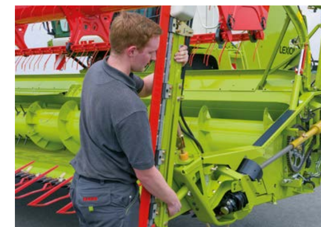
Montering af rapsknive med snaplås.
