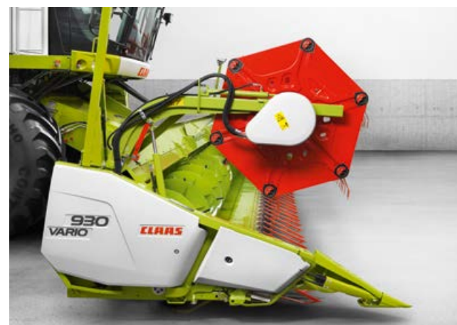
Knivgang kørt ind – korn (– 100 mm).
