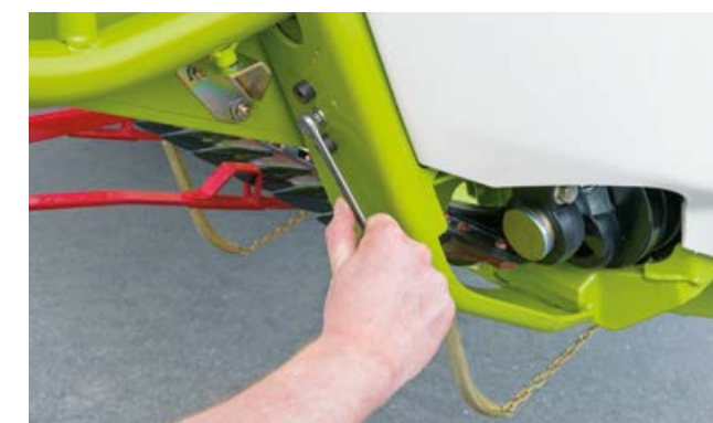
Enkel indstilling af stråskillerens højde med klappnøglen.
