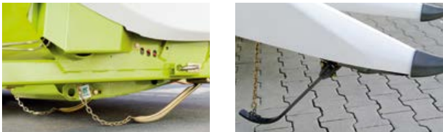
Tastebøjler registrerer frontudstyrets stilling til AUTO CONTOUR og CONTOUR.
