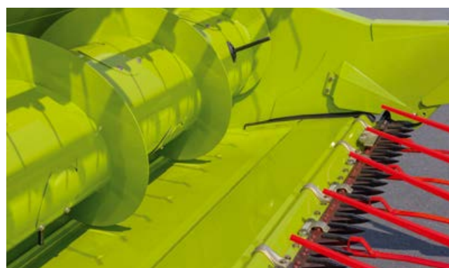
Knivgang kørt ud – korn (+ 100 mm).
