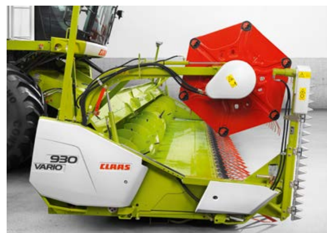
Knivgang kørt ud – med rapskniv (+ 600 mm).
