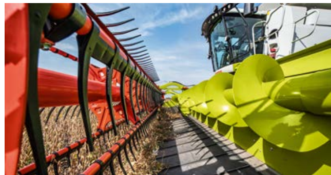
Flip-Over konseptin mukainen kaatokelapiikkien rataohjaus
