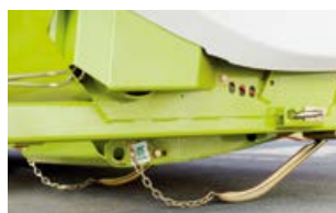
AUTO CONTOUR ja CONTOUR järjestelmissä tunnistinkaaret määrittelevät etuvarusteen asennon.
