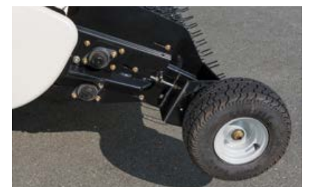
Kannatinpyörät rajoittavat käyttökorkeutta.
