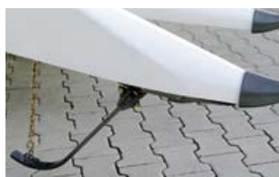
AUTO CONTOUR ja CONTOUR järjestelmissä tunnistinkaaret määrittelevät etuvarusteen asennon.
