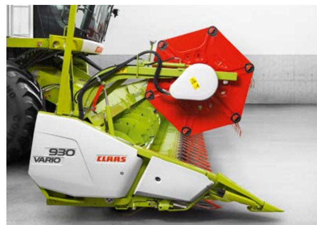
Leikkuupöytä lyhimmillään viljaa puitaessa (- 100 mm).
