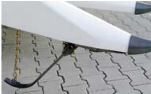
Palpeurs de position de l'outil frontal pour AUTO CONTOUR et CONTOUR
