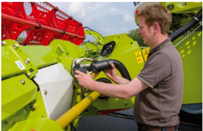
Multicoupleur et verrouillage centralisé pour plus de confort
