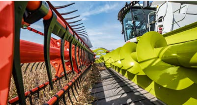
Rabatteur à came avec concept de retournement « flip over »
