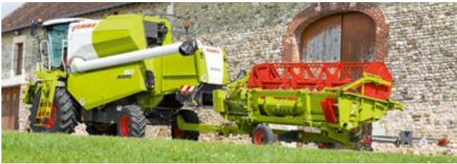
Grâce au chariot de coupe, le matériel peut être transféré simplement et rapidement, même lorsque les parcelles sont éloignées les unes des autres.
