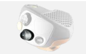
Activation de la régulation de la hauteur de coupe (AUTO CONTOUR), de la régulation de la pression d'appui et de la présélection de la hauteur de coupe, de même que le relevage et l'abaissement de l'outil frontal à l'aide de la poignée multifonction CMOTION
