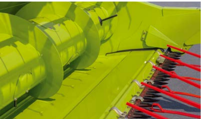
Tablier de coupe sorti – mode céréales ( +100 mm)
