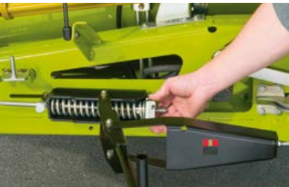
Associée au mouvement rectiligne, la tension correcte des tapis contribue à leur longévité.
