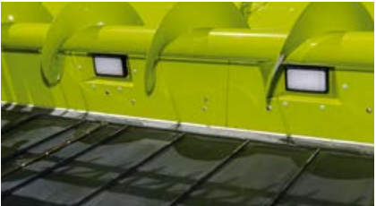
L'auge et la barre de coupe sont éclairés par des phares très puissants.
