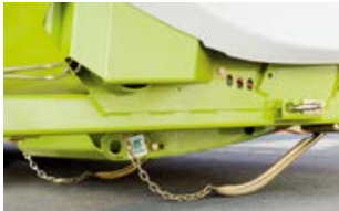
Palpeurs de position de l'outil frontal pour AUTO CONTOUR et CONTOUR
