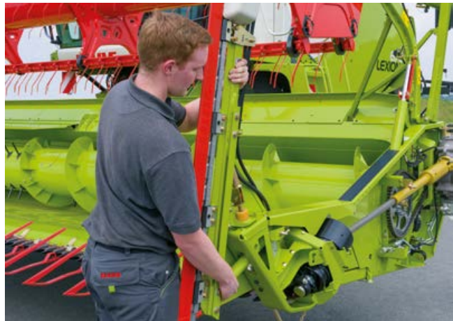
Système de verrouillage rapide pour le montage des scies à colza
