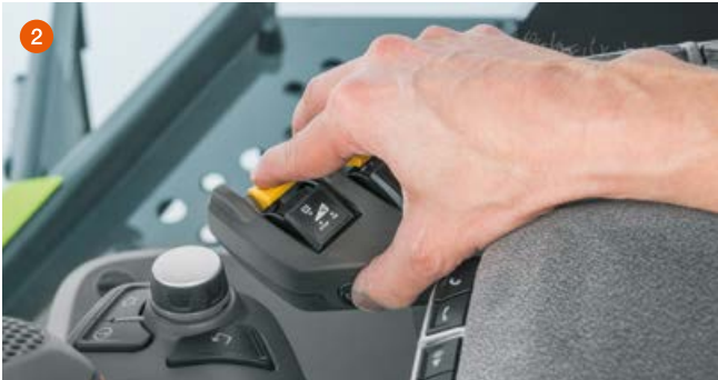
Inversion de mouvement via le levier CMOTION (1) ou par pression simultanée sur le basculeur et la touche d'inversion de mouvement (2)
