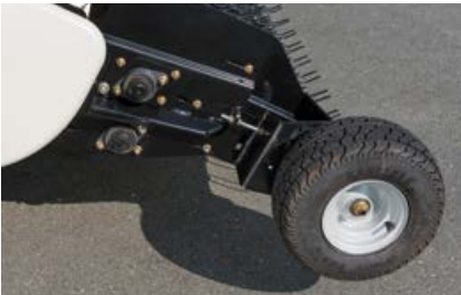
Les roues de jauge évitent le piquage des dents dans la terre.
