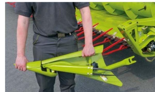
Schneller und einfacher Halmteilerwechsel.
