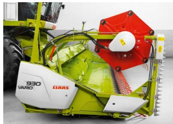
Schneidwerkstisch ausgefahren – mit Rapsmesser (+ 600 mm).
