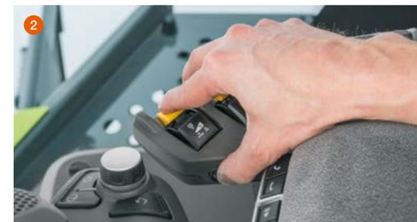
Reversieren über CMOTION (1) oder durch gleichzeitigen Druck auf Kippschalter und Reversiertaste (2)
