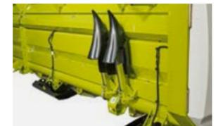
Einhängeposition am Schneidwerk für Halmteilerspitze bei Transport.
