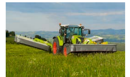
Det kompakte ophæng på frontliften giver slåmaskinen en stor frihøjde over jorden i forageren.
