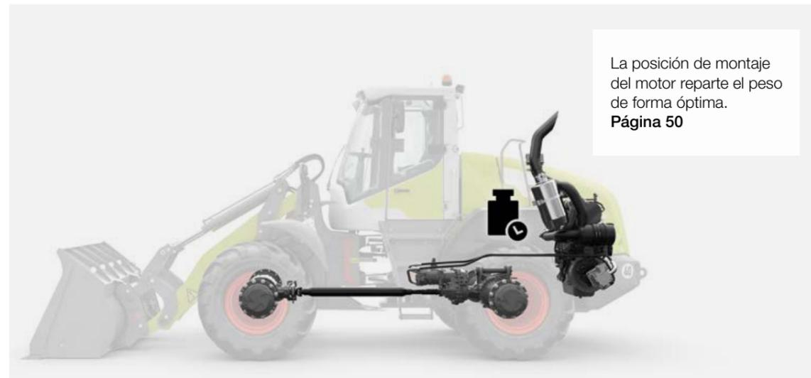
La posición de montaje del motor reparte el peso de forma óptima.
