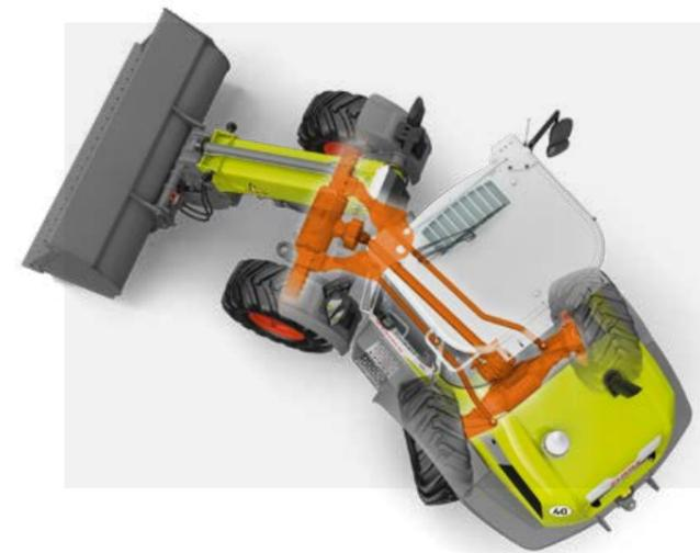
Gracias al gran ángulo pivotante, usted mantiene la estabilidad incluso cuando la cargadora de ruedas gira lateralmente en terrenos desnivelados. La TORION 738 T SINUS gira, en la articulación pivotante, en 8° hacia cada lado.
