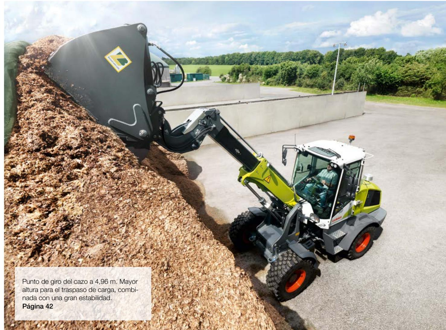
Punto de giro del cazo a 4,96 m. Mayor altura para el traspaso de carga, combinada con una gran estabilidad.
