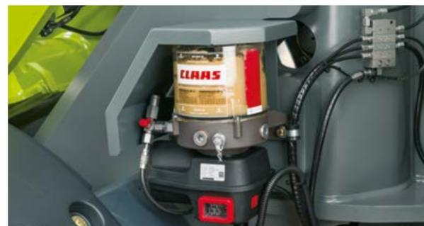
El depósito de abastecimiento del sistema de lubricación central se encuentra en el lado izquierdo de la máquina.
