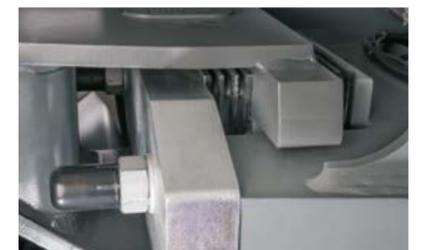
Amortiguadores de goma en la articulación pivotante incrementan el confort de trabajo.
