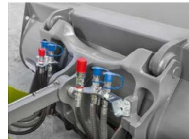
Todas las conexiones ofrecen un buen acceso y están protegidas en el portaherramientas. (956)
