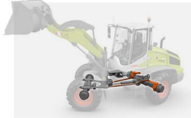
Precisamente con este objetivo se ha desarrollado el chasis de la TORION SINUS. La máquina no solo maniobra con la articulación pivotante en el centro, sino también con el eje trasero. Dos barras de dirección unen la parte delantera con las muñequillas traseras de los ejes. Desde que usted hace una maniobra moviendo el volante, el eje trasero actúa de forma sincronizada.
