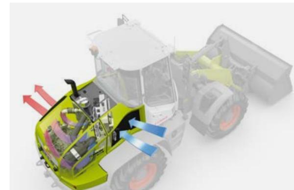
El filtro del radiador está colocado directamente detrás de la cabina, en la zona con poco polvo y poca suciedad. En el caso de que usted trabaje habitualmente en entornos muy sucios, se recomienda opcionalmente el montaje de un ciclón del filtro de aire que realiza una limpieza previa del aire aspirado.
