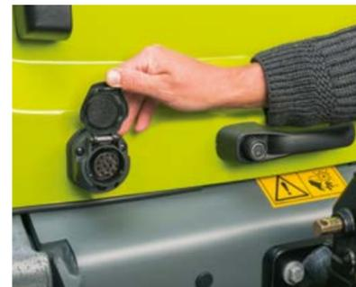
Caja de enchufe de 13 polos en la parte trasera para el trabajo con remolque
