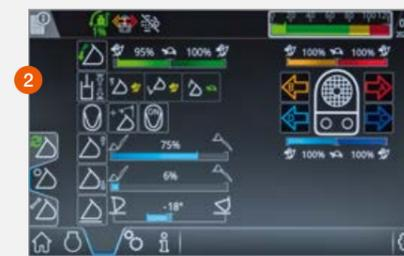
La limitación de la altura de elevación y la profundidad de descenso son mostradas en la pantalla táctil de 9 pulgadas.
