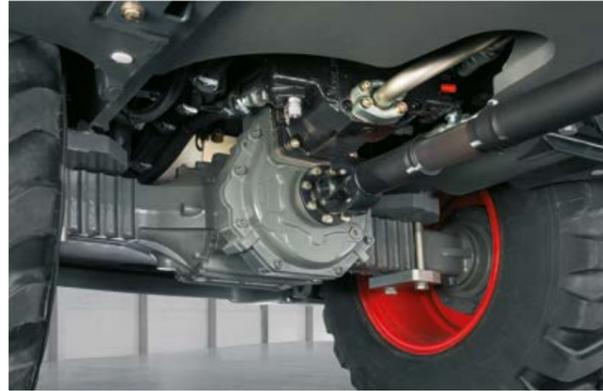
Caja de cambios hidrostática con efecto de frenado con autorretención
