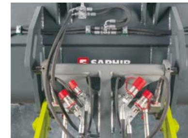
Retorno libre de la presión en la parte delantera y tubería adicional para las fugas de aceite con conexión en el portaherramientas. (644 / 537)
