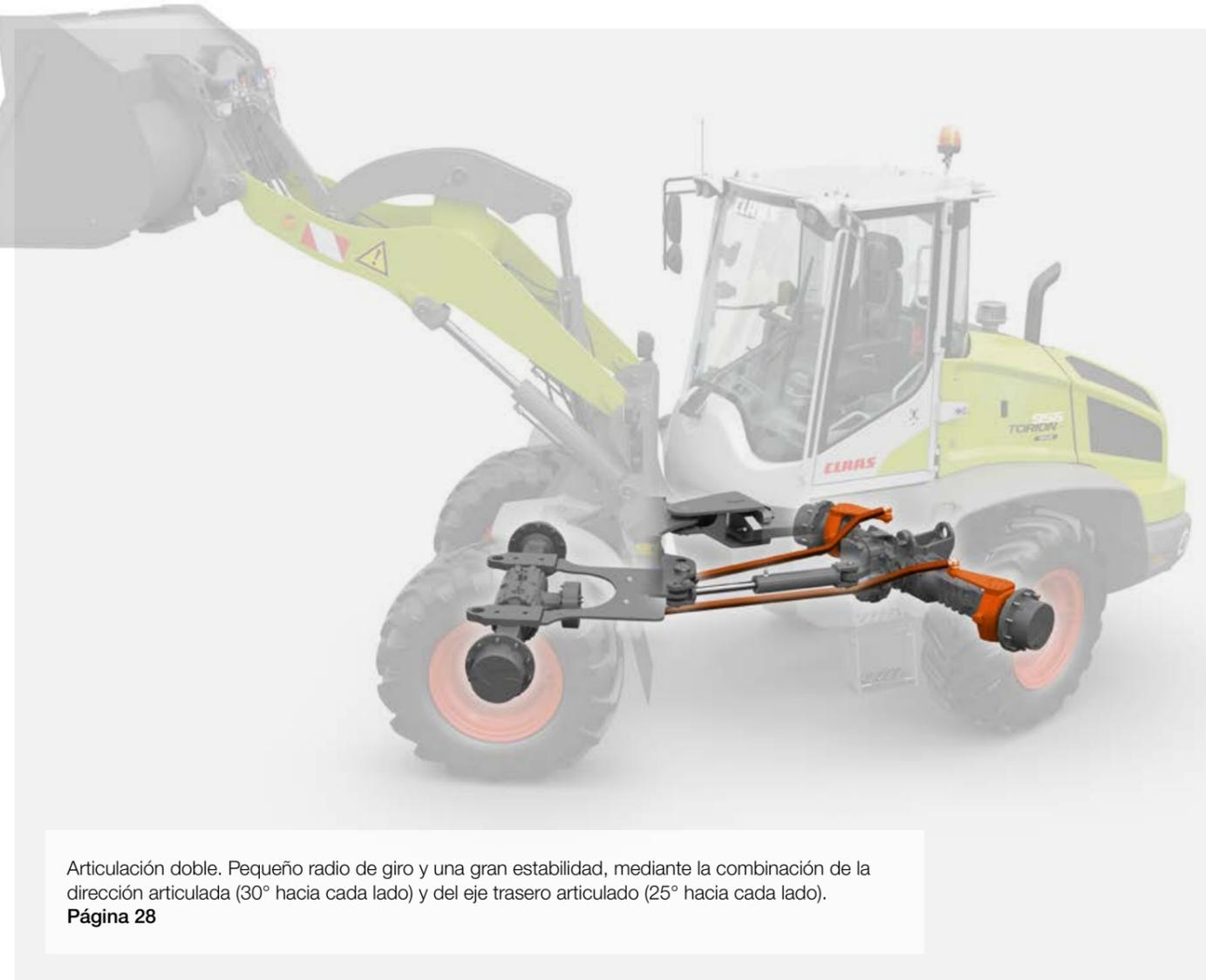
Articulación doble. Pequeño radio de giro y una gran estabilidad, mediante la combinación de la dirección articulada (30° hacia cada lado) y del eje trasero articulado (25° hacia cada lado).
