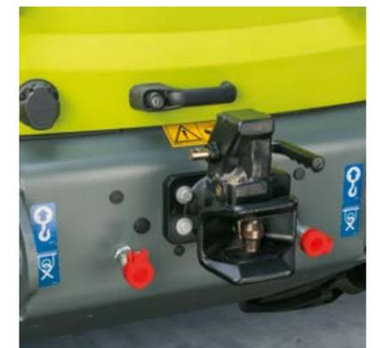
Usted obtiene opcionalmente circuitos adicionales para la parte delantera y trasera.
