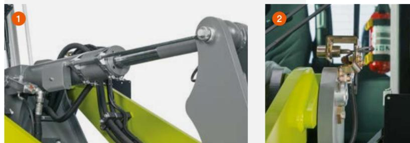
El retorno del cazo (1) y la limitación de la altura de elevación (2) se pueden ajustar mecánicamente de forma individual para cada implemento acoplado.
