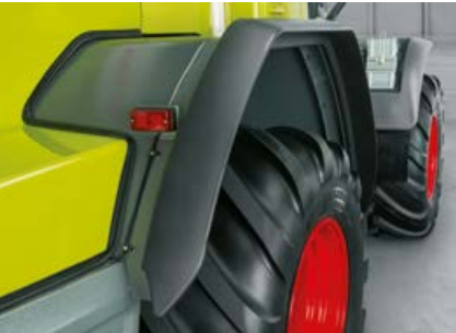
Lai pilnībā nosegtu ļoti platus riteņus, riteņu arkas ir iespējams ar starpliku palīdzību paplašināt.
