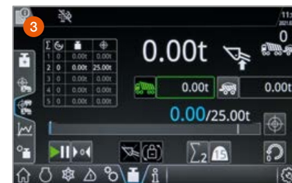
Svēršanas sistēma precīzi mēra un dokumentē dienā veiktos iekraušanas un izkraušanas daudzumus.
