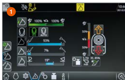
Pacelšanas un nolaišanas augstumu iestatījumi saglabā ideālu līmeni līdz zemei un izgāšanas augstumu.
