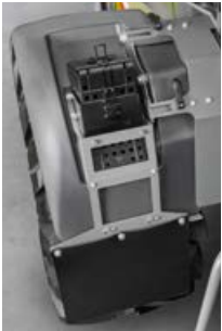
TORION 1511 P modelim jūs varat elastīgi pielāgot dubļusargus, lai skābbarības tranšejā varētu strādāt bez sadursmēm.
