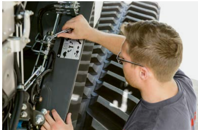
Превключвате ръчно двата диапазона на оборотите на редуктора на оборотите на вършачния барабан чрез хидравличен клапан.
