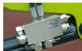
Grazie alla commutazione elettrica sulle serie FL e FL C, le valvole di sicurezza possono essere combinate con lo smorzatore di oscillazioni SHOCK ELIMINATOR.
