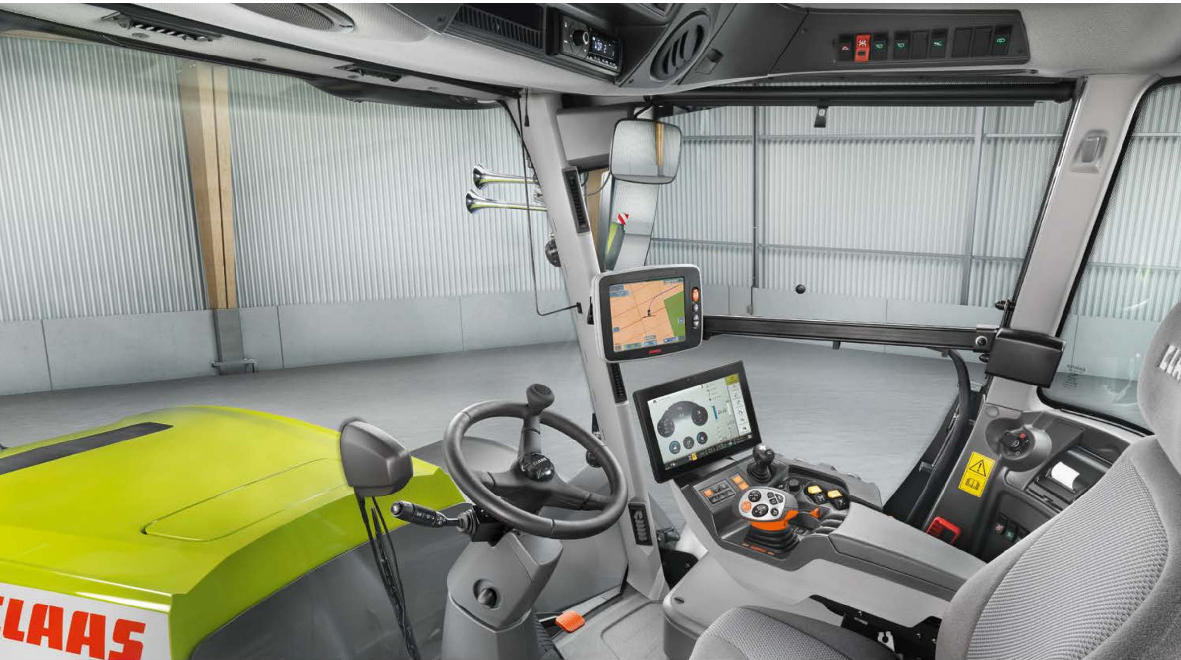
El TRAC VC dispone del dispositivo de marcha atrás más confortable del mercado. Su cabina se puede girar en menos de 30 segundos en 180°.
