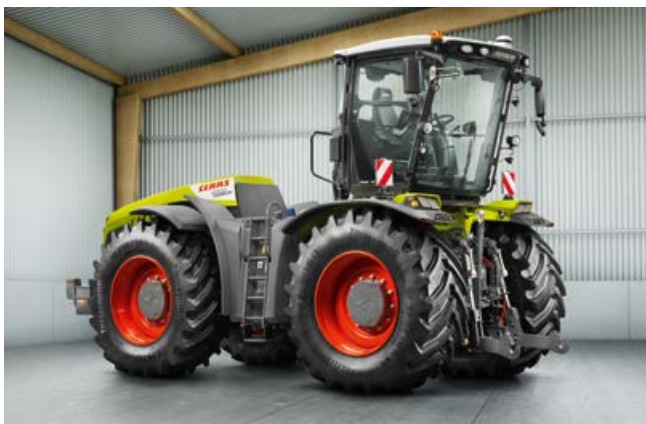
El TRAC VC dispone del dispositivo de marcha atrás más confortable del mercado. Su cabina se puede girar en menos de 30 segundos en 180°.
