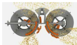
Aktīvais kļedētājs ar minimālu jaudas patēriņu efektīvi izkļedē smalcinātos salmus
