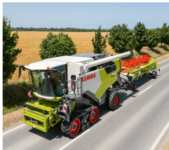
Visas TERRA TRAC kāpurķēdes ir pilnībā piemērotas braukšanai pa ceļu līdz 30 km/h, un tās var vadīt ērtāk nekā riteņu mašīnas.
