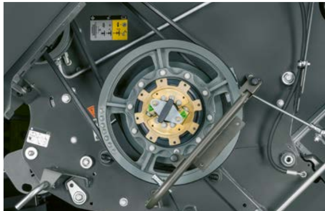
Turația tocătorului de paie poate fi adaptat simplu, rapid și fără scule la lucrarea desfășurată.
