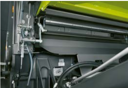
Den store steinfellen kan lett åpnes og tømmes.
