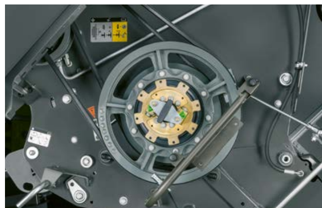
Halmsnitterens omdrejningstal kan let og hurtigt tilpasses til arbejdet uden værktøj.
