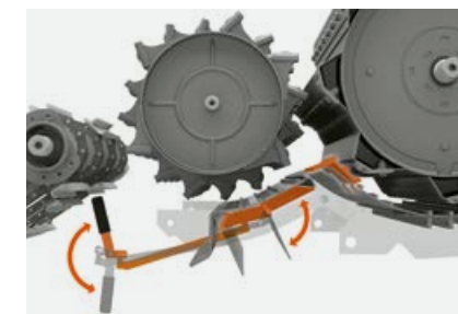
Forbroklapper kører og fjerner avner.
