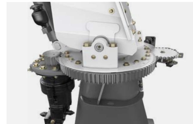
Tugev pöördketas, mis sobib just nõlvadel või suurel kiirusel toimuvaks saagikoristuseks.
