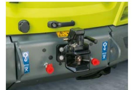
TORION 956 SINUS izvēles opcija ir bezspiediena hidrauliska atplūde aizmugurē
