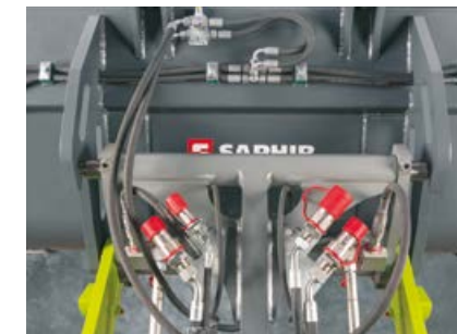
Bezspiediena atplūde priekšā un papildu noplūdes eļļas vads ar savienojumu ar darba agregātu turētāju (644/537)
