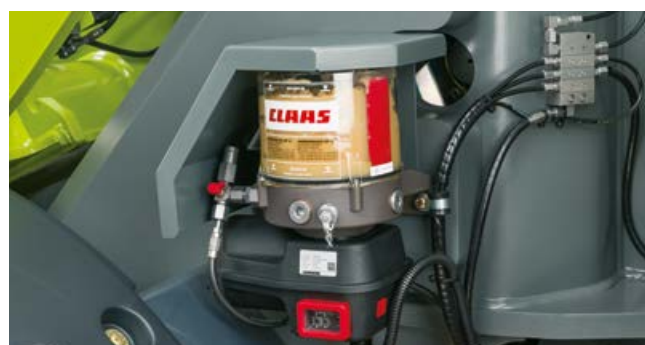
Centrālās eļļošanas sistēmas tvertne atrodas mašīnas kreisajā pusē
