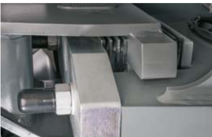
Gumijas amortizatori šarnīrveida svārsta savienojumā palielina komfortu.
