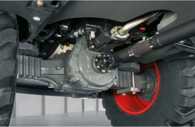
Hidrostatiska transmisija ar pašbremzēšanos
