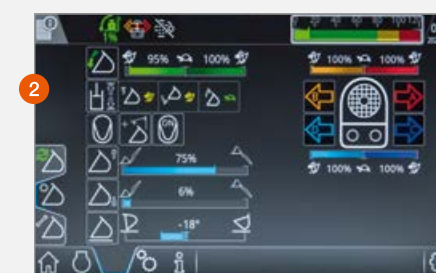
Pacelšanas un nolaišanas augstuma robežas tiek attēlotas 9 collu skārienekrānā
