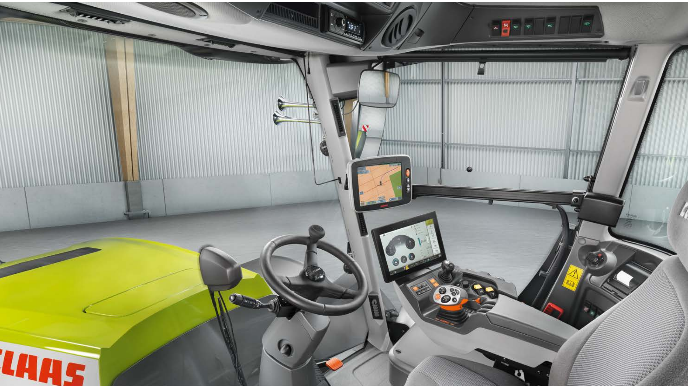
TRAC VC er markedets mest komfortable to-veis traktor. Førerhuset kan dreies 180° på under 30 sekunder.
