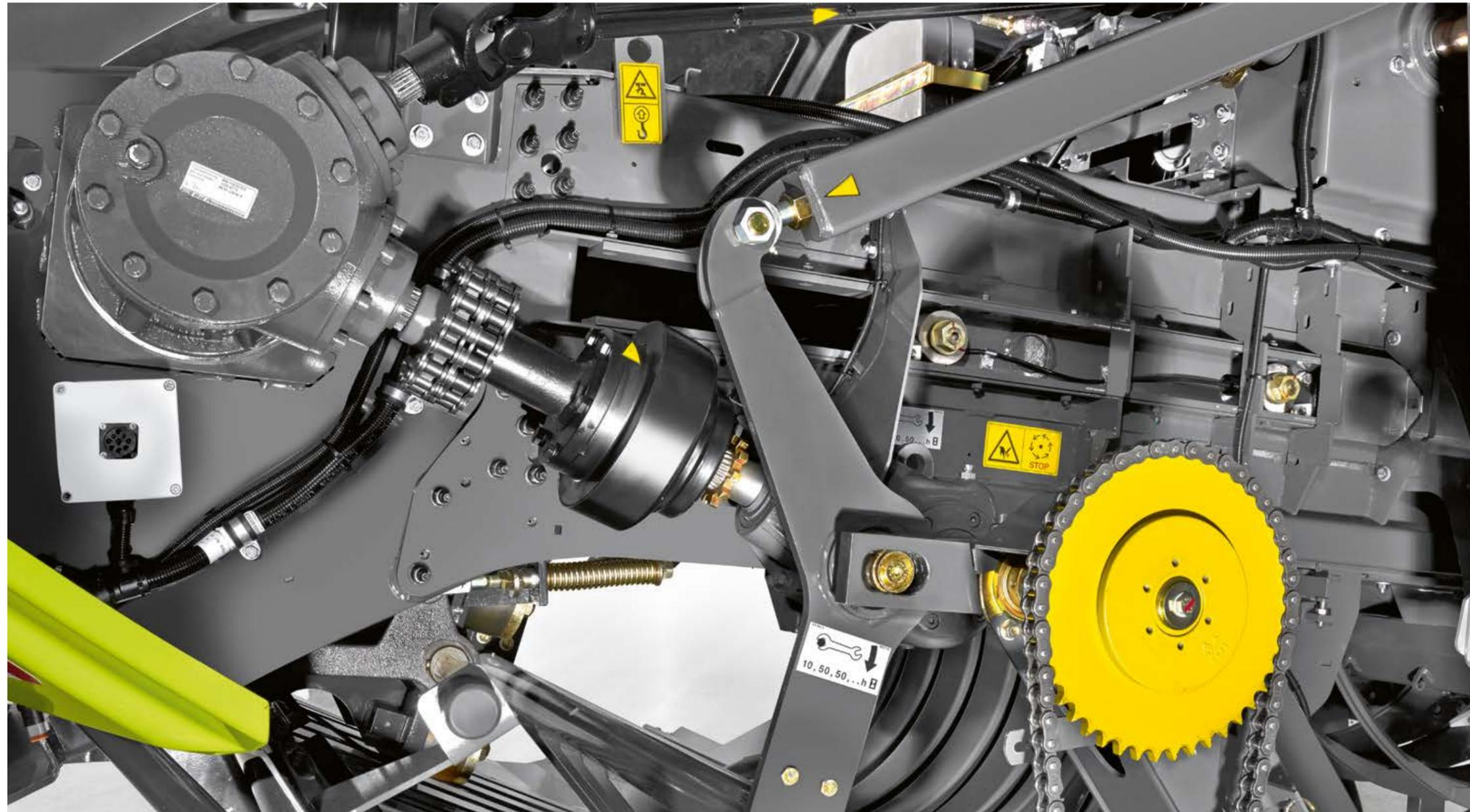
Auch der Presskolben wird durch eine Abschaltkupplung vor Überlastungen geschützt. Alle Überlastkupplungen rasten nach Runterfahren der Zapfwellendrehzahl automatisch wieder ein. Sie brauchen im Störfall den Traktorsitz nicht zu verlassen.
