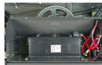
Аккумуляторная батарея на 12 В для питания бортового электронного оборудования и электроники двигателя. Удобный доступ в отсеке для аккумуляторной батареи.
