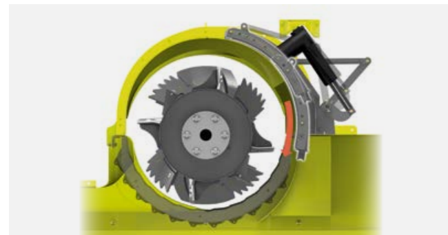
Направляющий щиток ротора
