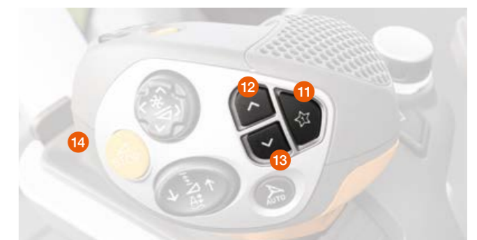
Рычаг управления SMOTION: выбор избранной функции (11), выбор избранного на уровне выше (12) или ниже (13), настройка значения с помощью кнопки (14)
