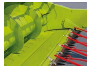
Стол жатки выдвинут – уборка зерновых (+100 мм)
