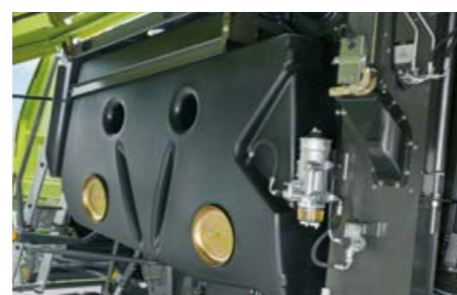
Топливный бак объемом до 750 л
