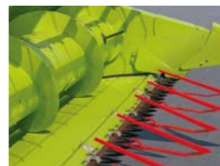
Стол жатки задвинут – уборка зерновых (-100 мм)
