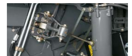
Гидравлический модуль управления очисткой 3D
