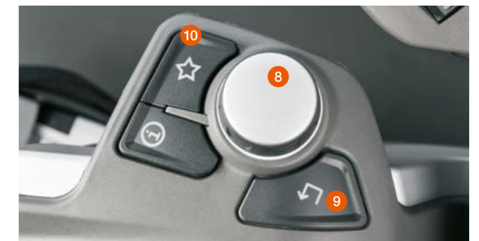
Панель управления CEBIS: поворотный переключатель (8), клавиша Escape (9), управление избранным (10)
