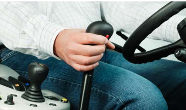
2 Bouton d'embrayage sur le levier de commande pour un changement simple des rapports
