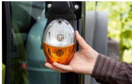
Les feux de position rabattables sur le NEXOS VE évitent d'endommager les cultures.
