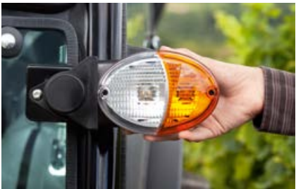
Les feux de position rabattables sur le NEXOS VE évitent d'endommager les cultures.
