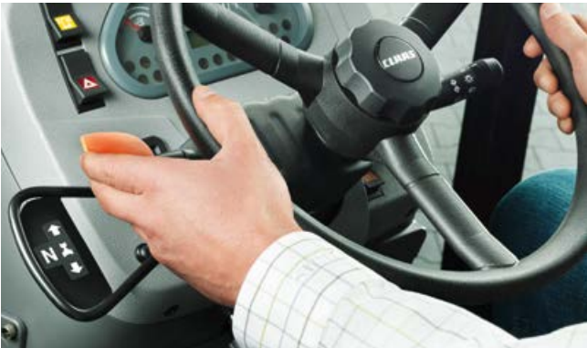
1 Levier REVERSHIFT pour les manœuvres rapides, notamment en tournière ou pour empiler des caisses
