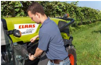
L'arceau se replie en quelques secondes et sans outil.
