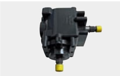
Através da posição de montagem da engrenagem de entrada fica disponível uma rotação lenta ou rápida para todo o ORBIS.
