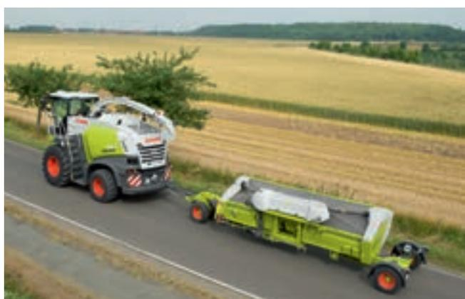
O DIRECT DISC é colocado sobre o carro de transporte e também é travado sem a necessidade de ferramentas. Assim, você está seguro em velocidades de até 40 km/h.
