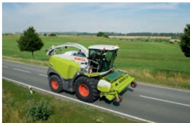
Para espigas de milho com uma largura operacional de até 6 m, as peças laterais são dobradas na vertical. O ORBIS 750 e o ORBIS 900 são dobrados um sobre o outro. Para garantir que as cargas dos eixos estejam em conformidade com as leis é oferecido um sistema de transporte integrado, opcional no ORBIS 750 e de série no ORBIS 900.
