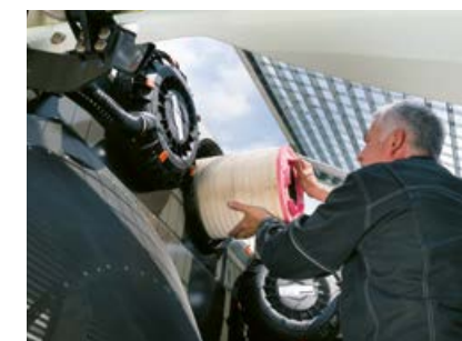
Замена воздушного фильтра без использования инструментов
