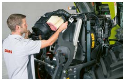
Motorens luftfilter er plassert foran radiatorene og er lett å rengjøre.
