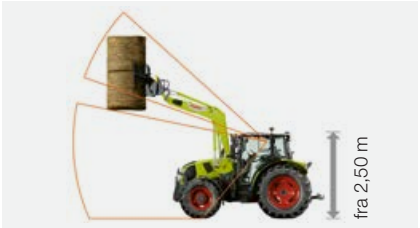
Førerhus med lavt tak og takluke: Gjennomkjøringshøyde fra 2,50 m.
