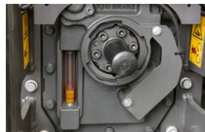
Du kan sjekke oljenivået i transmisjonen og hydraulikksystemet via et nivåglass ved siden av kraftuttakstappen.
