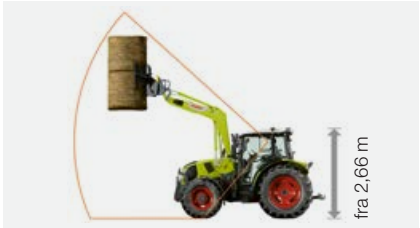
PANORAMIC førerhus med hel frontrute opp til glasstaket for maksimal sikt og minste totalhøyde på 2,66 m
