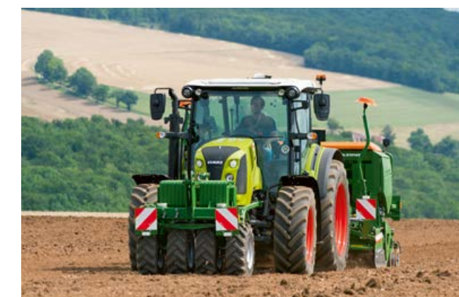
Den sterke trepunktshydraulikken foran gjør traktoren meget allsidig.
