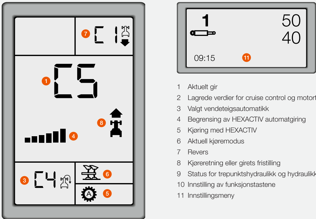
CIS skjerm i instrumentpanelet og gir-skjerm i A-stolpen.
