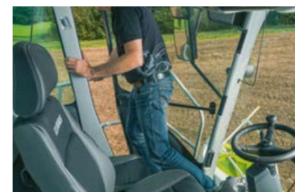
Датчик сиденья автоматически выключает приставку и главный привод.
