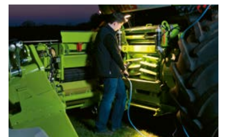
QUICK ACCESS обеспечивает проверку органов измельчения в течение нескольких минут.
