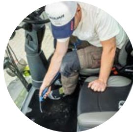
Пневматический пистолет в кабине для очистки
