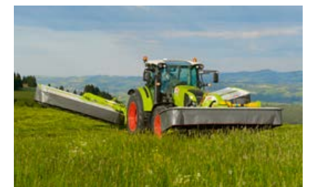
Kompakt trepunktsupphängning ger slåttermaskinen hög markfrigång på vändtegen.
