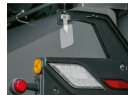
Viskesuuna automaatreguleerimise andur.
