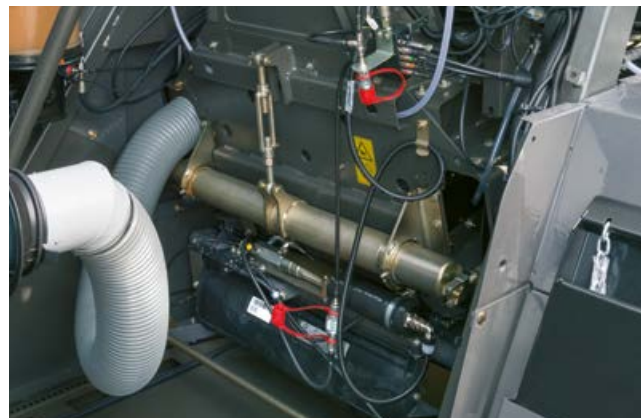
A kidobóventilátor pozíciójának mechanikus állítása
