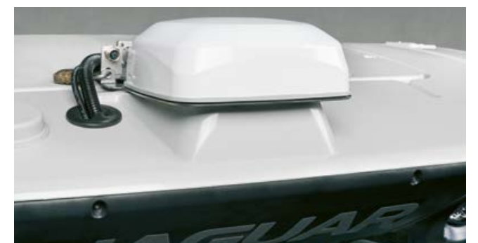
SAT 900 antenna és vevő egyben - lopásgátlóval
