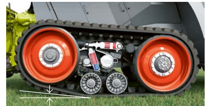
66% felfekvési felület: Az előlső hajtókerék 100 mm-re emelkedik fel.
