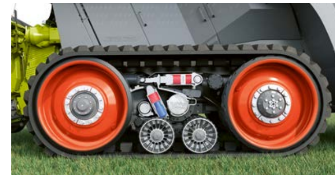
100% felfekvési felület: Az előlső hajtókerék teljes mértékben érintkezik a talajjal.
