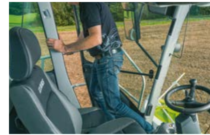
Az üléskapcsoló automatikusan kikapcsolja az adaptert és a fő hajtóművet.
