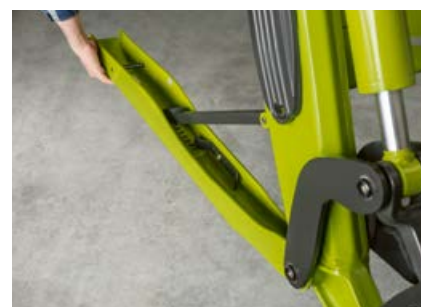
Støttebenene klappes op under stolpen, så de ikke forstyrrer udsynet over frontlæsseren.
