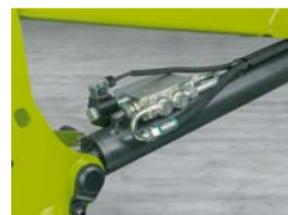
Grâce à la commande électrique sur les séries FL et FL C, les clapets de sécurité peuvent être combinés au système d'amortissement SHOCK ELIMINATOR.
