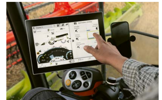
Pilotage intelligent de la machine grâce à CEMOS AUTOMATIC sur CEBIS
