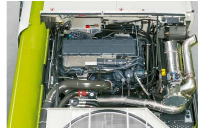
LEXION 8900 / 8800 avec moteur MAN D42 de 581 kW/790 ch
