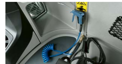
Soufflette dans la cabine pour un nettoyage rapide de l'espace intérieur entre deux chantiers
