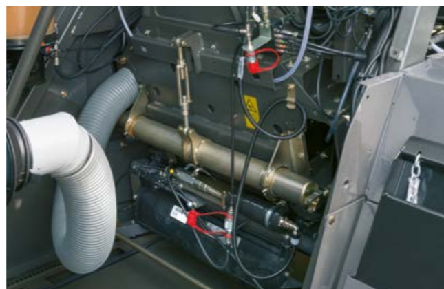
Mechanische Spalteinstellung des Auswurfbeschleunigers
