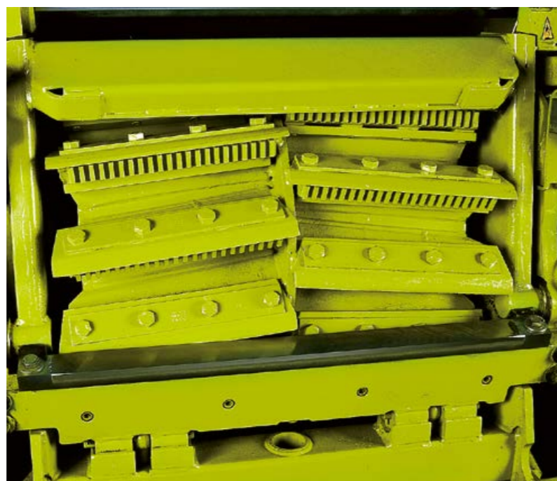
Mikroschlagleisten unter den Messern für zusätzliche Erntegutauflbereitung
