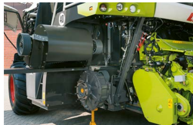
Einfacher Aus- und Einbau des Beschleunigers
