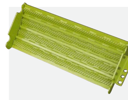
Fondo del cilindro con elementos de fricción para el acondicionado adic. del material de cosecha
