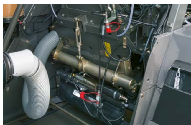
Механическая регулировка зазора выходного ускорителя
