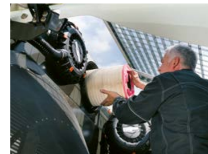
Замена воздушного фильтра без использования инструментов
