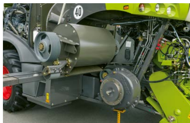
Простой монтаж и демонтаж ускорителя
