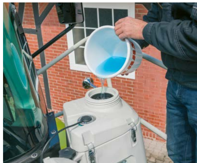
Заполнение бака консерванта
